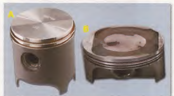
A. Pistón de dos tiempos B. Pistón de cuatro tiempos
